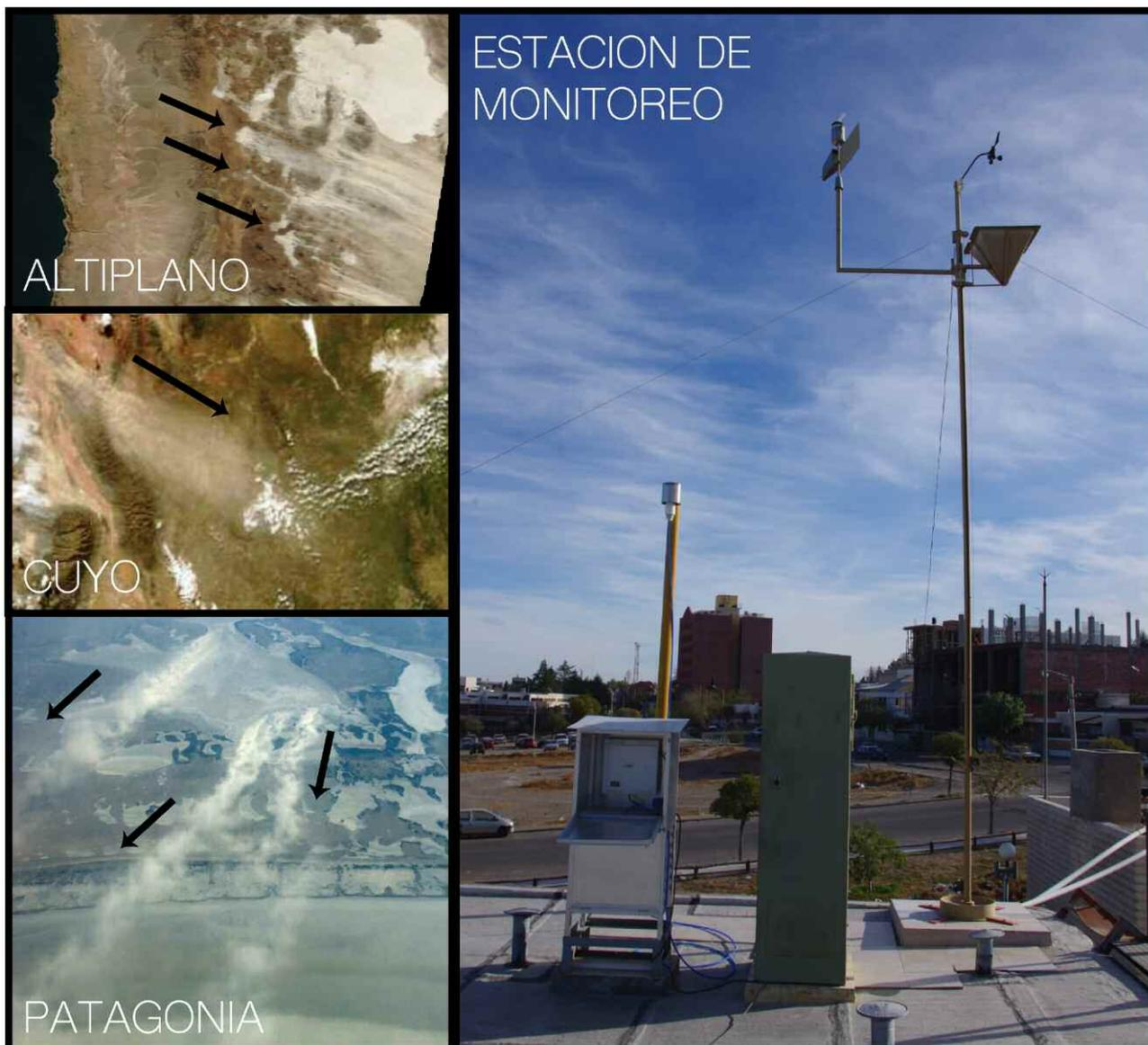
**Figura 2.** Tormentas de polvo en las principales zonas generadoras de aerosoles minerales en el sur de América del Sur, y captos pasivos utilizados para medir el flujo de polvo atmosférico. Imágenes satelitales tomadas de NASA WorldView (<http://worldview.earthdata.nasa.gov>).
